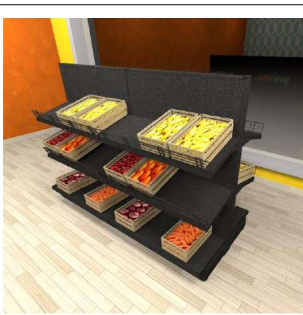
Gondola di produzione cinese con passo da 25. Gondola in ferro completo di: schienali, piano base unico, piani unici forati completi di mensole regolabili in altezza, piani per frutta e verdura inclinabile a 14° gradi con profondità 50, completo di carter inferiore. Scaffalatura metallica di serie colore Grigio Grafite Ral 7024 (Piani esclusi di portaprezzi optional aggiuntivo su richiesta).
